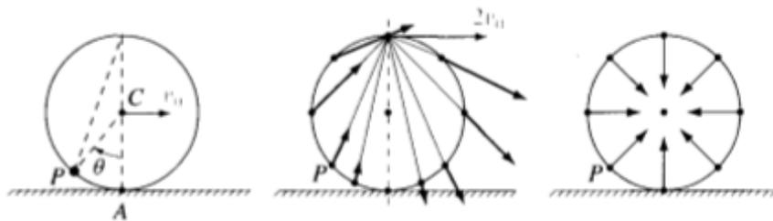
Abbildung 3: Position, Geschwindigkeit und Beschleunigung der Zykloide.
